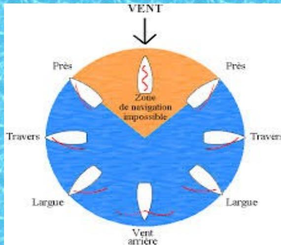
Pour aller dans le sens du vent (vent arrière), il suffit d'ouvrir les voiles pour qu'elles offrent le maximum de surface au vent. Les voiles sont positionnées perpendiculairement au bateau.. Le vent pousse le bateau dans son sens, il ne penche pratiquement pas.
